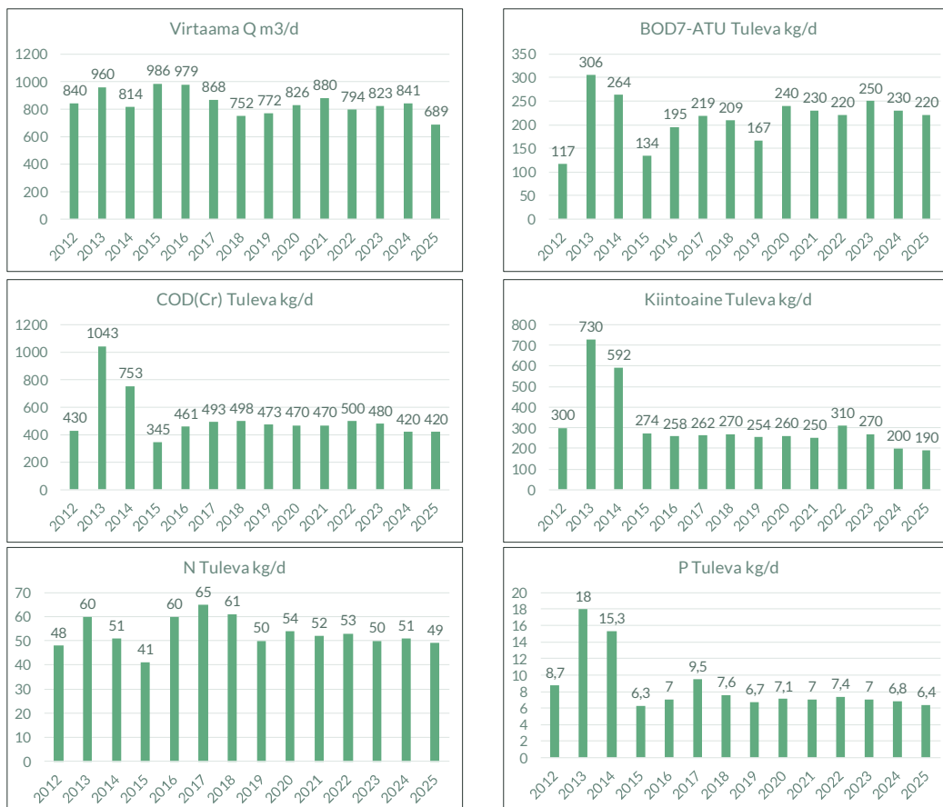
Kuvat 2–7. Puhdistamon viemärikuormituksen vaihtelu vuosina 2012–2025.
